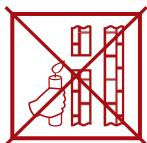
недостаточная тяга (Не используйте котел!)
