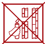
слабая тяга (Не используйте котел!)
