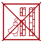
недостаточная тяга (Не используйте котел!)
